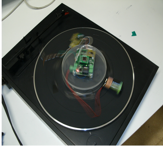
Figura 4.2: Configuração para a calibração do giroscópio.
