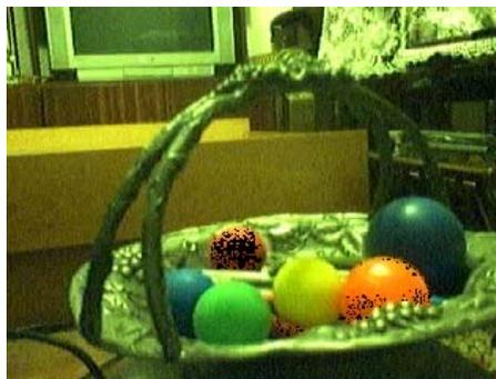
Figura 5.12: Segmentação baseada em croma usando uma lista de cores numa *frame HSV*.
